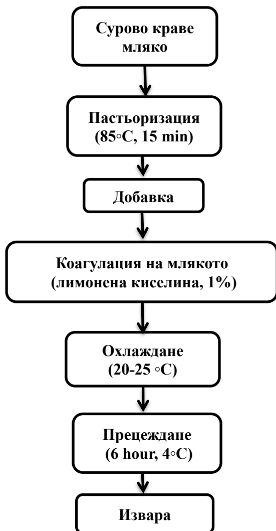
Фигура 1. Технологична схема за получаване на извара
